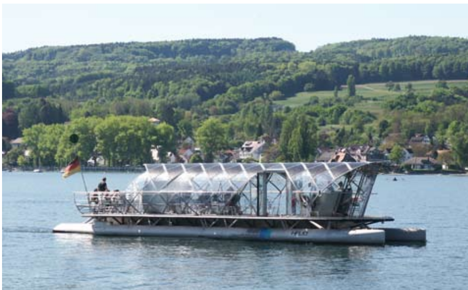
Innovation am Untersee: Das Flaggschiff der Solarboote am Untersee ist die elegante Solarfahre RA66 HELIO, zugelassen als Fahrgastschiff für den Transport von 50 Personen und 25 Fahrrädern. © R. Kirchmann
